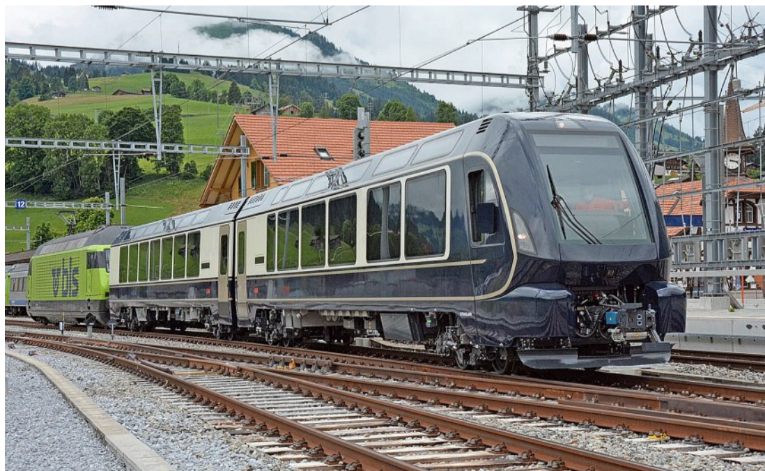
Der umspurbare Testzug verlässt erstmals den Bahnhof Zweisimmen Richtung Boltigen. Foto: Guido Lauper
